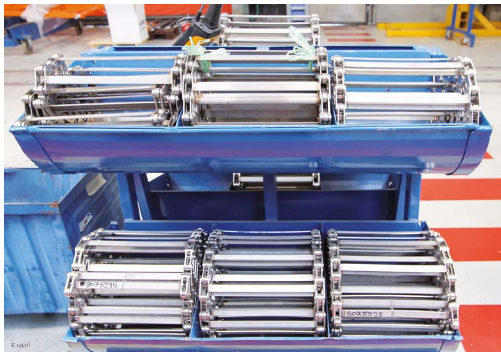
Il sistema di estrazione del materiale con nastro metallico trasferito da Giletta dalle macchine agricole agli spargisale, è ciò che ha determinato il successo dell'azienda in questo settore.
