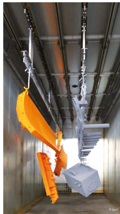
Pezzi verniciati all'interno di uno dei forni.
