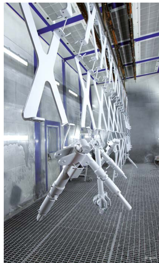
Applicazione della finitura a polvere in una delle due cabine apposite.
