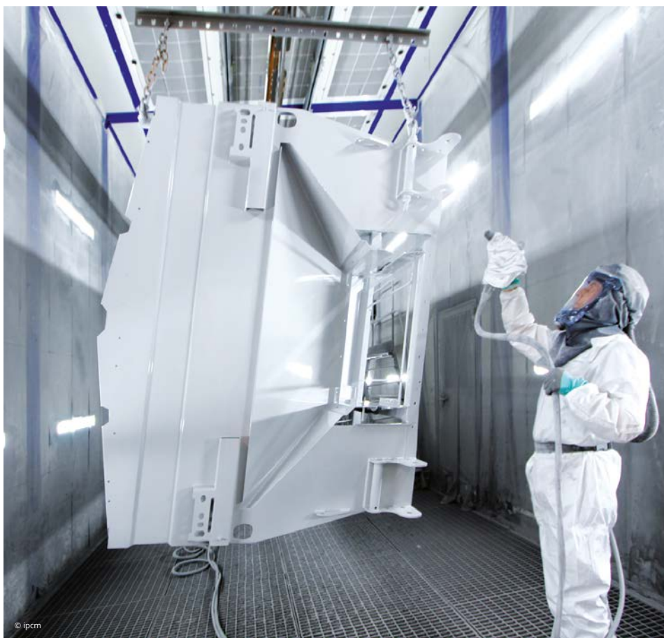
Applicazione del fondo liquido in una delle due cabine pressurizzate a flusso verticale.
