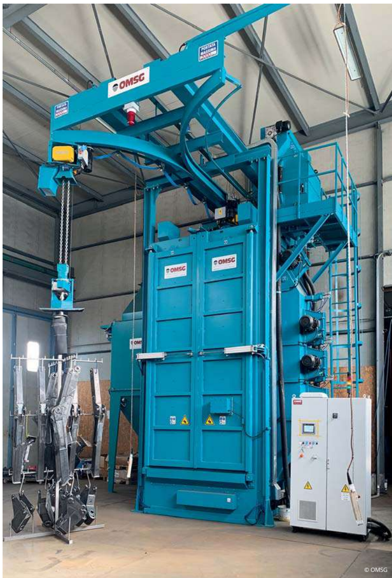
La nuova granigliatrice a grappolo modello Capri 20/35 H22.
