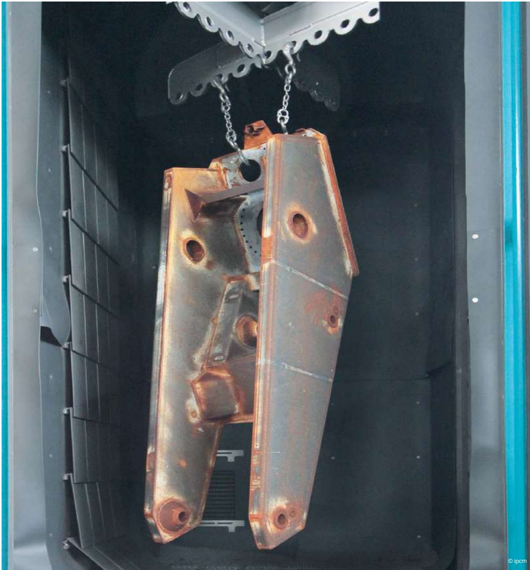
Dettaglio della camera di sabbiatura.
