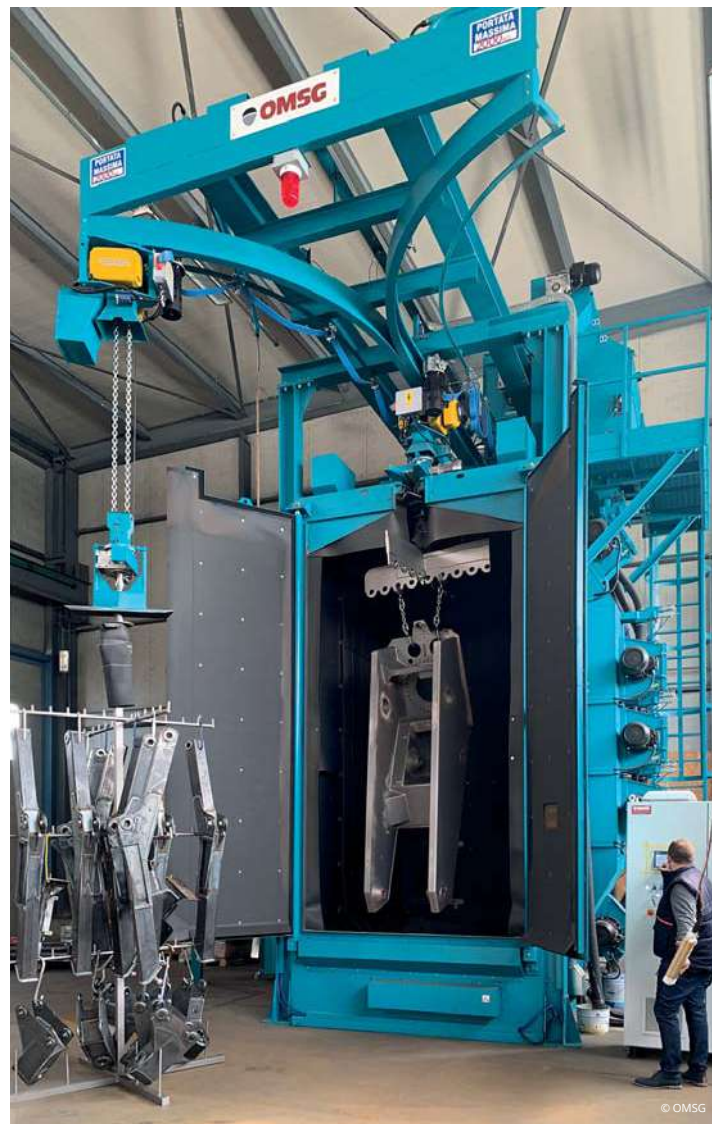
Ingresso di un manufatto nella nuova granigliatrice.
