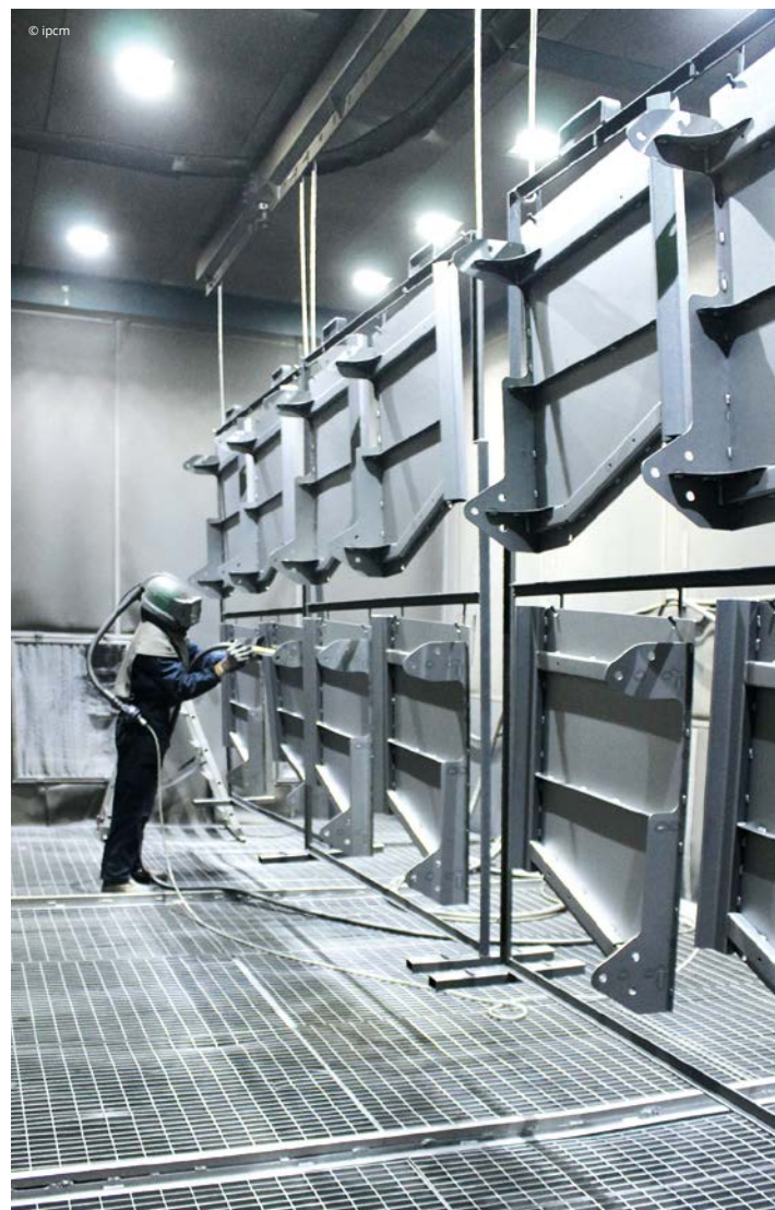
La camera di soffiatura e sabbiatura manuale di Vespa Sabbiatrici posta in linea con la granigliatrice.
