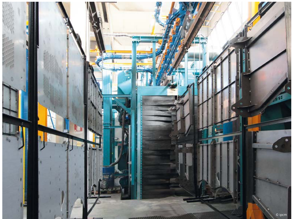
Pezzi appesi all'ingresso della granigliatrice automatica a tunnel TUNNELBLAST 1525/12 SP di OMSG. La macchina OMSG a 12 turbine è abbinata a un filtro autopulente da 20.000 m³/h e, sia all'ingresso che all'uscita, presenta delle bandelle in gomma antiusura che impediscono la fuoriuscita di abrasivo metallico.
