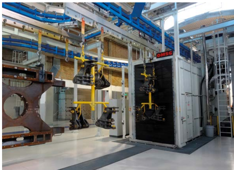
Tappeto rampante di OMSG e un esempio di lavorazione attraverso macchina granigliatrice OMSG.
